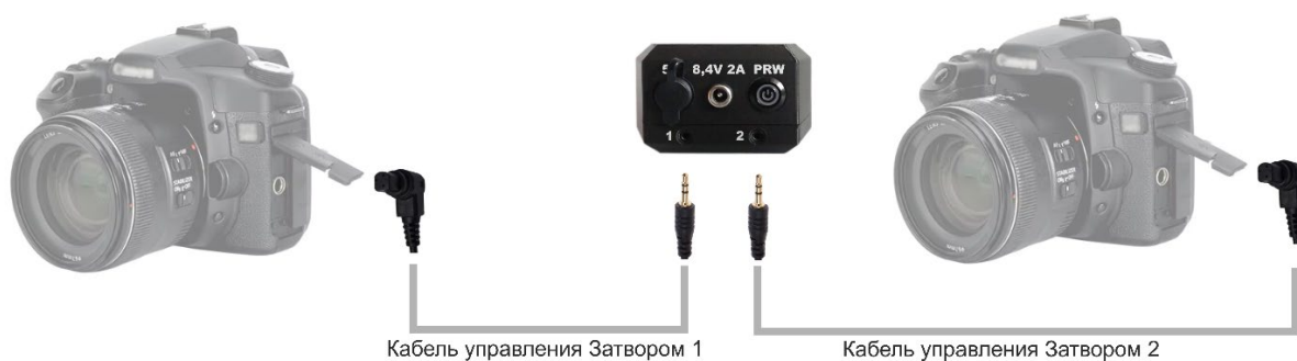
Рис. 4. Схема подключения двух фотоаппаратов к Shoot-Maker
