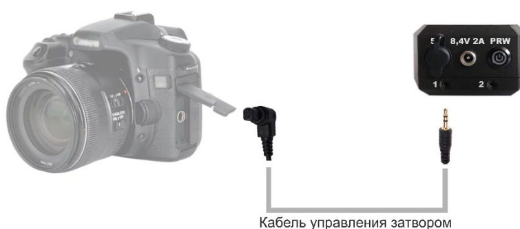
Рис. 2. Схема подключения фотоаппарата к Shoot-Maker
