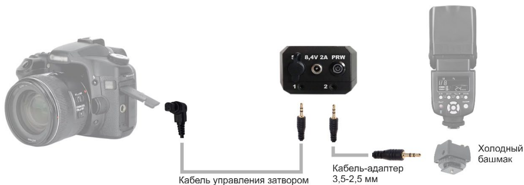
Рис. 3. Схема подключения фотоаппарата и вспышки к Shoot-Maker
